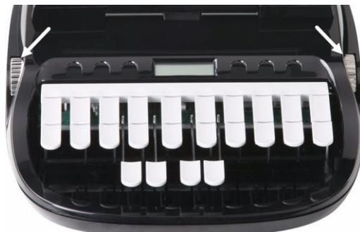
La molette de réglage de la profondeur de frappe, sur la gauche, détermine la hauteur de la barre des numéros et toutes les touches de sténotypie. Cela permet de déterminer l'enfoncement des touches lorsque vous appuyez dessus. Dix paramètres sont à la disposition de vos besoins.
